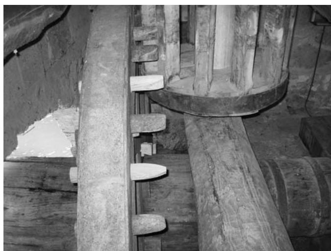
Fig. 4. Reconstrucción del eje, rueda, entruesga y carro, que servían para el movimiento de una aceña tradicional del río Duero, en las Aceñas de Olivares, Zamora (Foto: J. M. Garrido).
